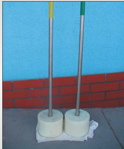
Ubijaki do jelit Stampfer zum Verpacken von gesalzenen Naturdärmen im Fass Rammers used to pack dry salted casings in the casks
